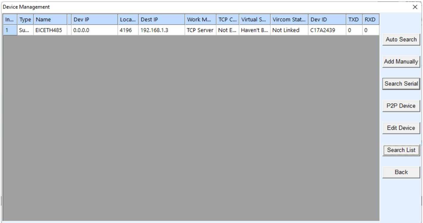
3. Após aparecer o dispositivo EICETH485 na janela de **Device Management**, clique no botão **Edit Device** para configurar os parâmetros.
