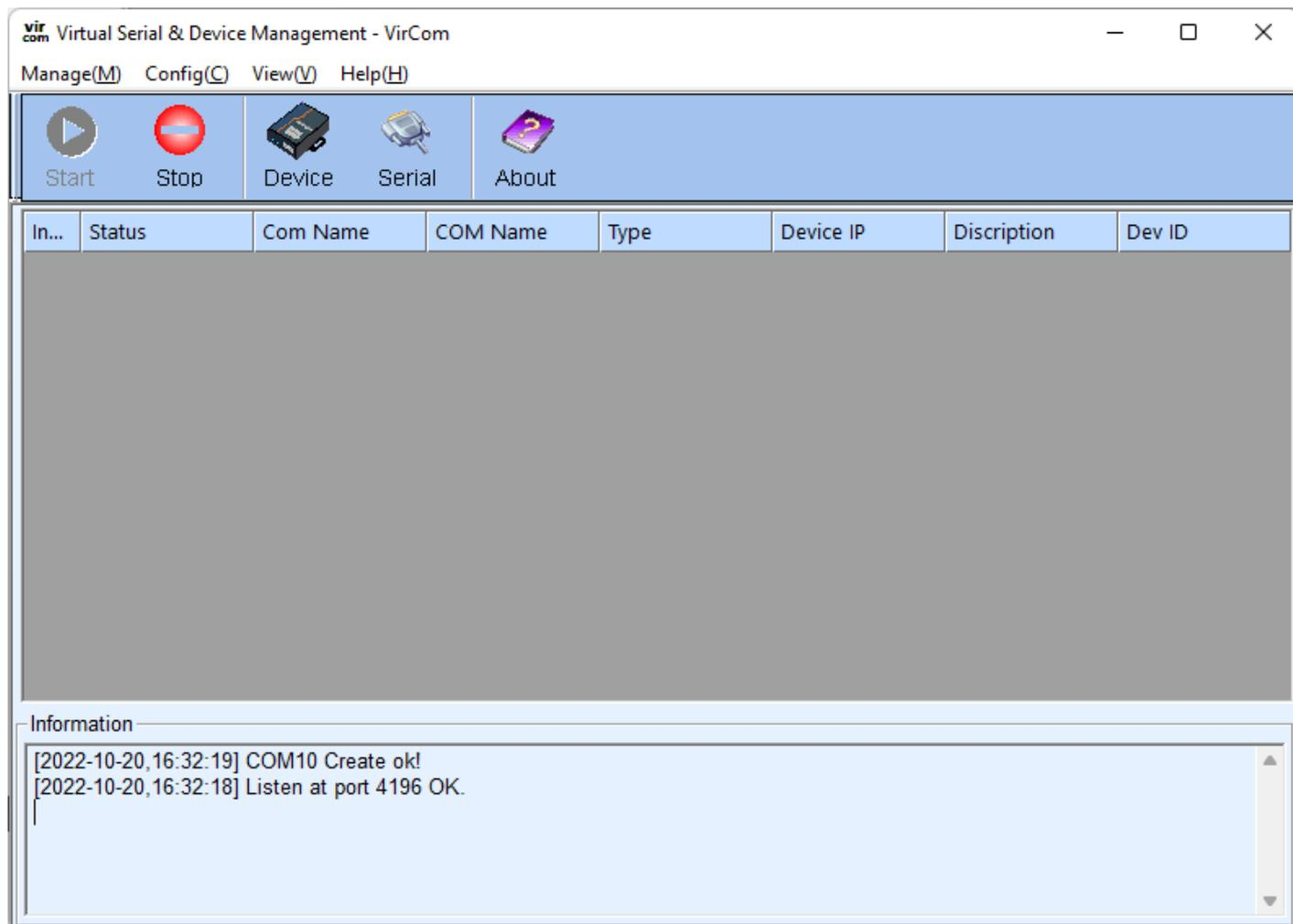
2. Clique no botão **Device** para localizar a interface na rede, lembrando que a interface precisa estar na mesma rede que computador.
