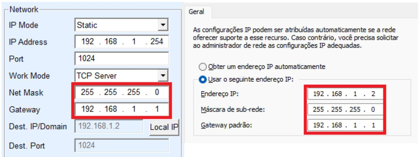
Seja conectado diretamente ou através de um switch, quando configurado como IP estático, o dispositivo e o computador precisam estar no mesmo segmento de rede, como mostrado na Figura acima. Como o VirCom oferece suporte à pesquisa e configuração em diferentes segmentos de rede, o endereço IP pode ser pesquisado, mas não pode ser comunicado pois não está configurado corretamente. Neste caso, você pode usar o VirCom para configurar o dispositivo para mesma rede.
